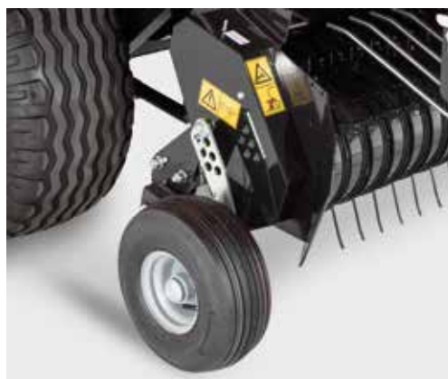
Ruotini del pick-up removibili a regolazione rapida Removable pick-up wheels with quick regulation Abnehmbare Pick-up Räder. Einfache Höhenverstellung der Pick-up Räder Demontowalne koła podbieracza z szybką regulacją Съемные колеса подборщика с быстрым регулированием
